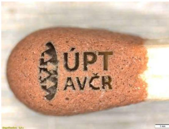
*Miniaturna loga vyřezaná v Mikroobráběcím centru Ústavu přístrojové techniky AV ČR – výsledky práce laserového systému, který dokáže obrábět nejtvrďší materiály nebo popsat hlavičku zápalky. Téma laserů je součástí sobotního programu ve stánku tohoto ústavu.*
